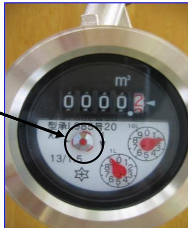
少しでもパイロットが回っていれば、メーターの先で漏水していると考えられます。
